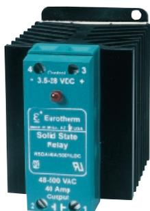
Os Relês de Estado Sólido Tiristorizados RSDA/RSAA montados em trilho DIN de construção fixa, permitem uma forma econômica de fornecer energia a cargas resistivas. O dissipador de calor integral simplifica a montagem e garante adequada remoção de calor quando montado de forma apropriada.
